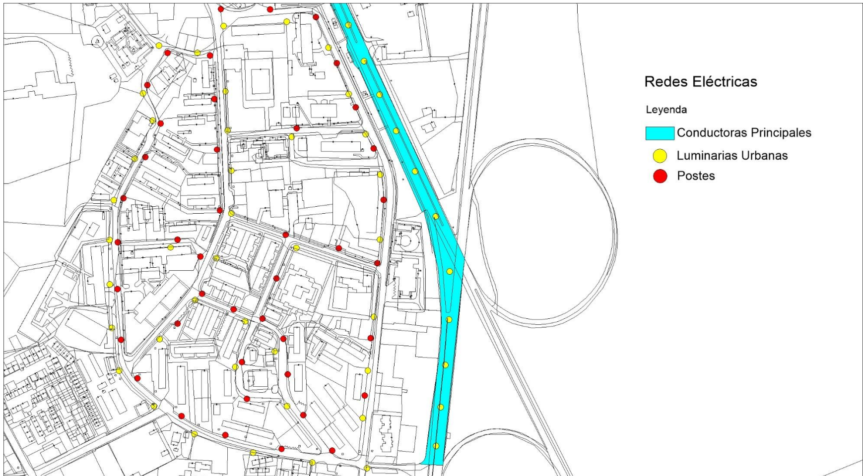
Figura 2.133: Plano de redes eléctricas. Fuente: Elaboración propia.
