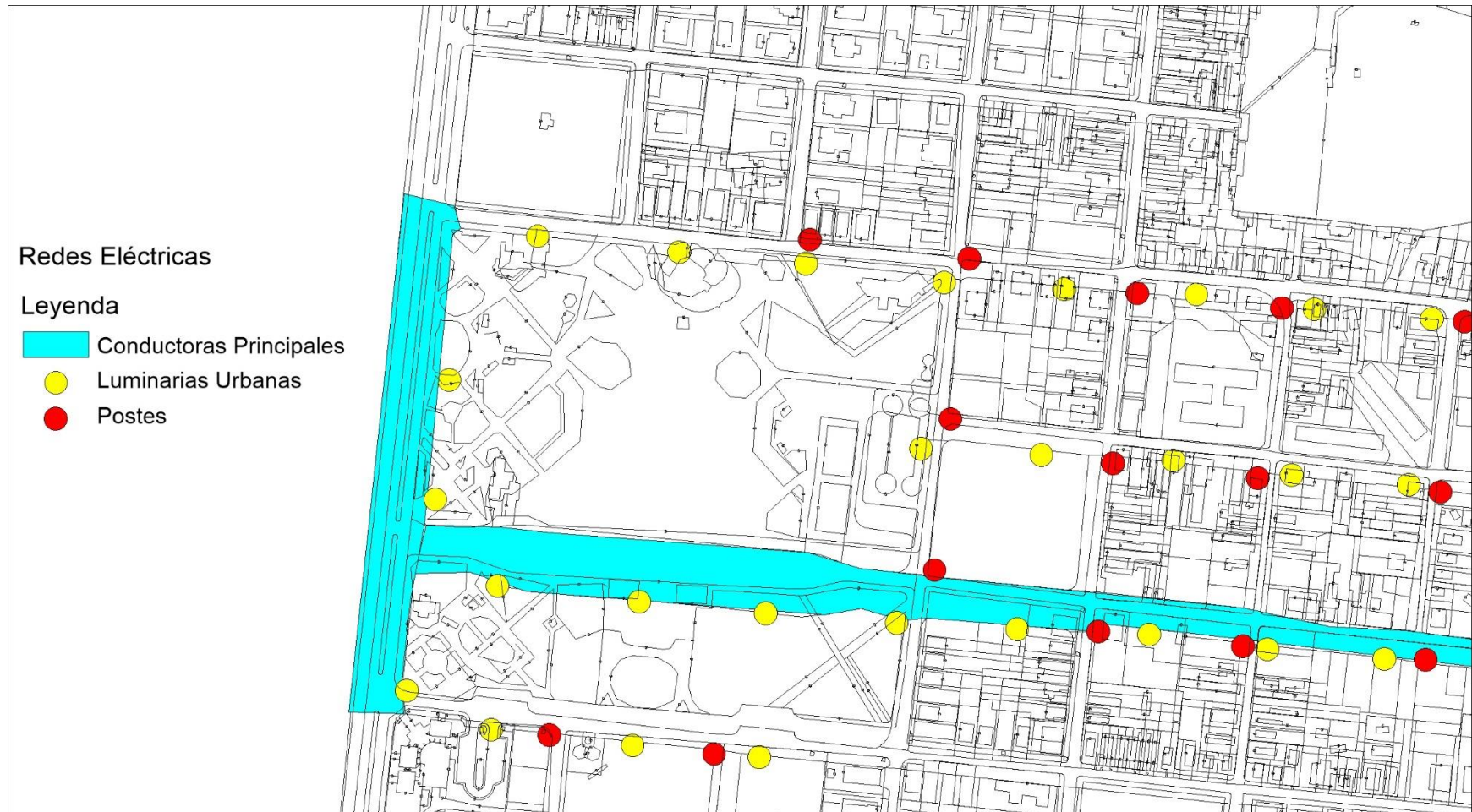
Figura 2.77: Plano de redes eléctricas. Fuente: Elaboración propia.
