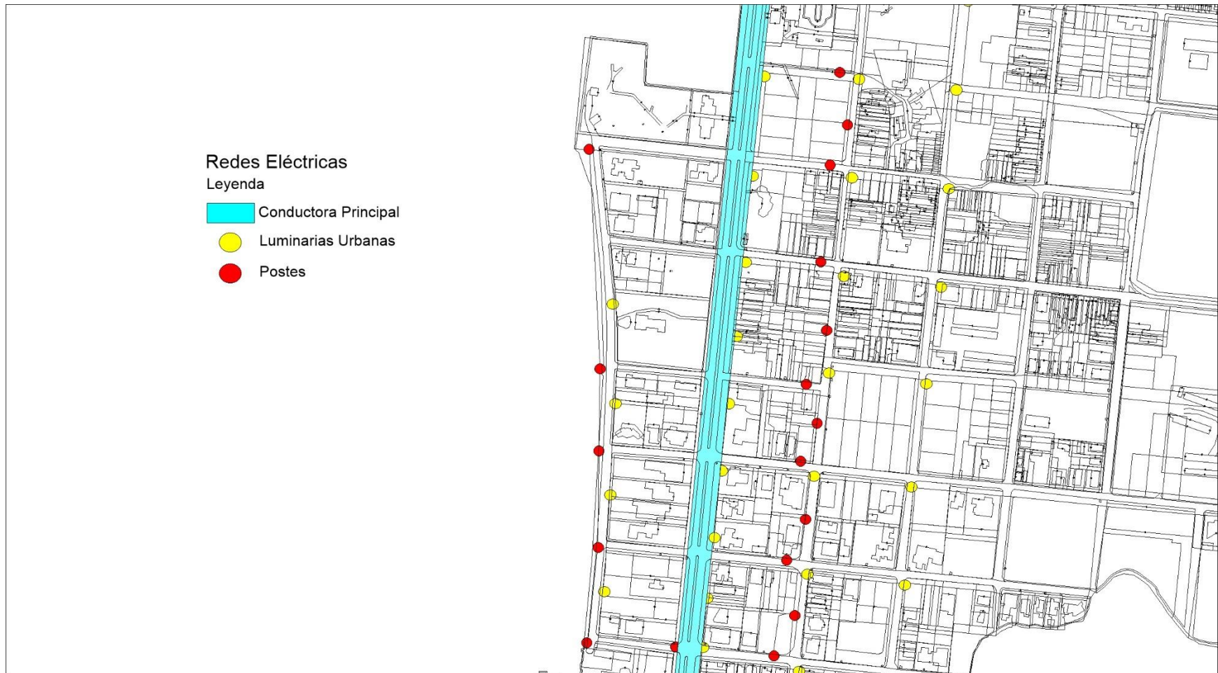
Figura 2.58: Plano de redes eléctricas. Fuente: Elaboración propia.
